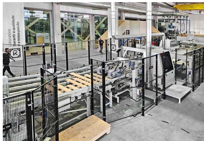
Eine Hochleistungs-Keilzinkenanlage des Typs Opti-Joint H-L von System TM verbindet die Hölzer zu bis zu 13 m langen Lamellen
