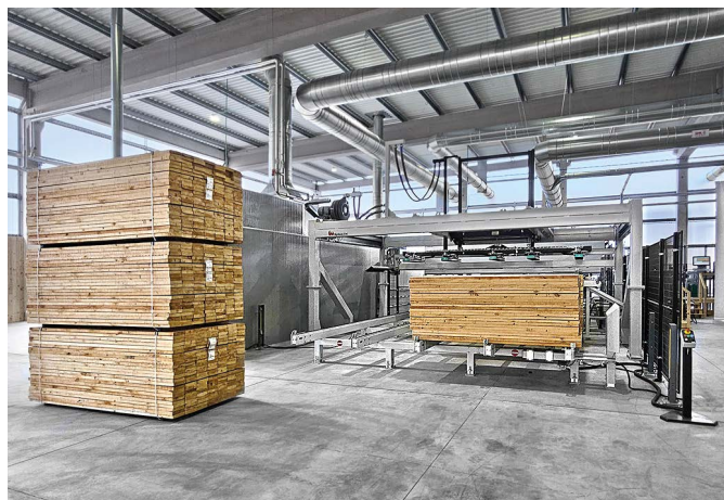
Eine Vakuum-Entstapelungsanlage des Typs Opti-Feed 6000 Vack von System TM vereinzelt die Pakete
