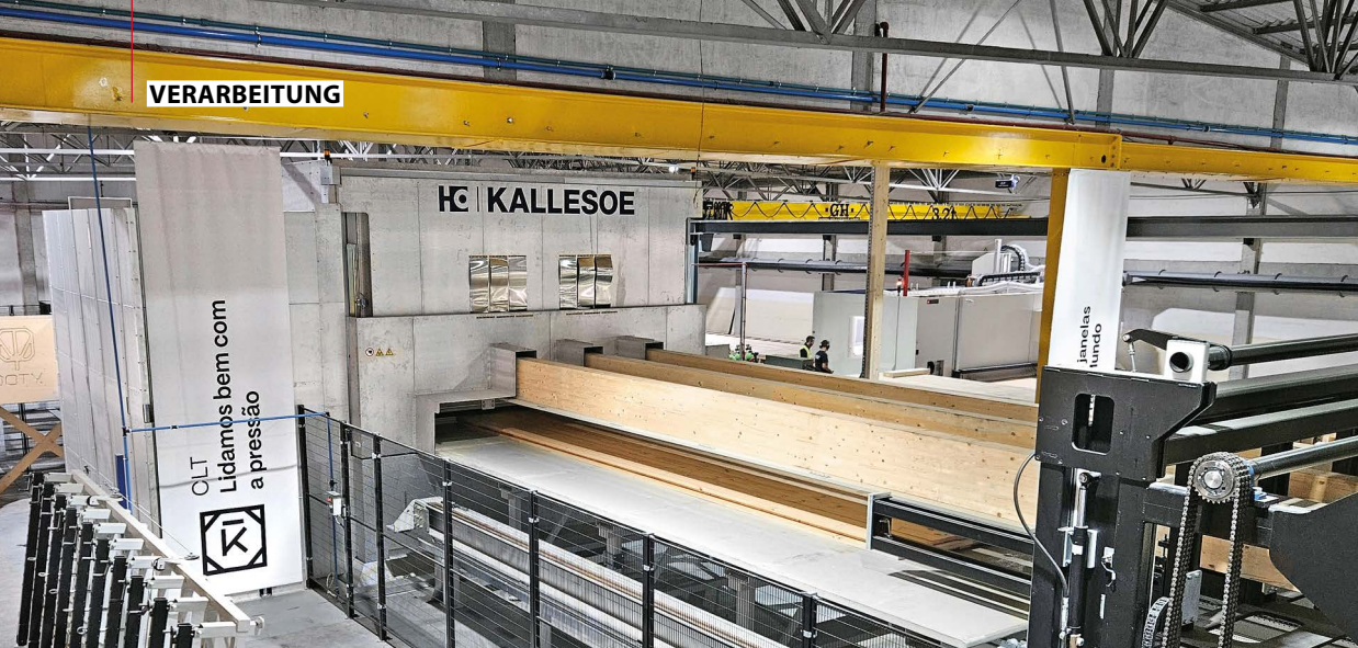
Gemeinsam mit System TM realisierte Kallesoe bei Kozowood in Portugal eine komplette BSP-Linie
